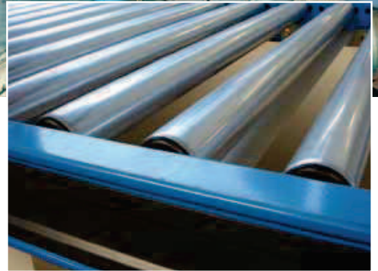
Détail d'un châssis avec carter sans aspérité.
